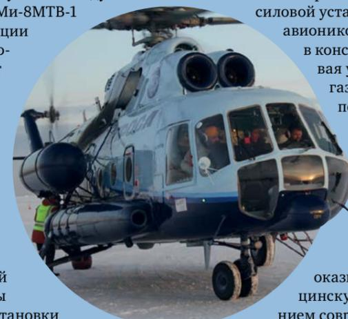
Вертолет МИ-8МТВ-1 имеет улучшенные летно-технические характеристики. Он отличается от вертолета Ми-8Т более мощной силовой установкой, доработанной авионикой и рядом изменений в конструкции фюзеляжа. Силовая установка состоит из двух газотурбинных двигателей по 2200 лошадиных сил каждый.
